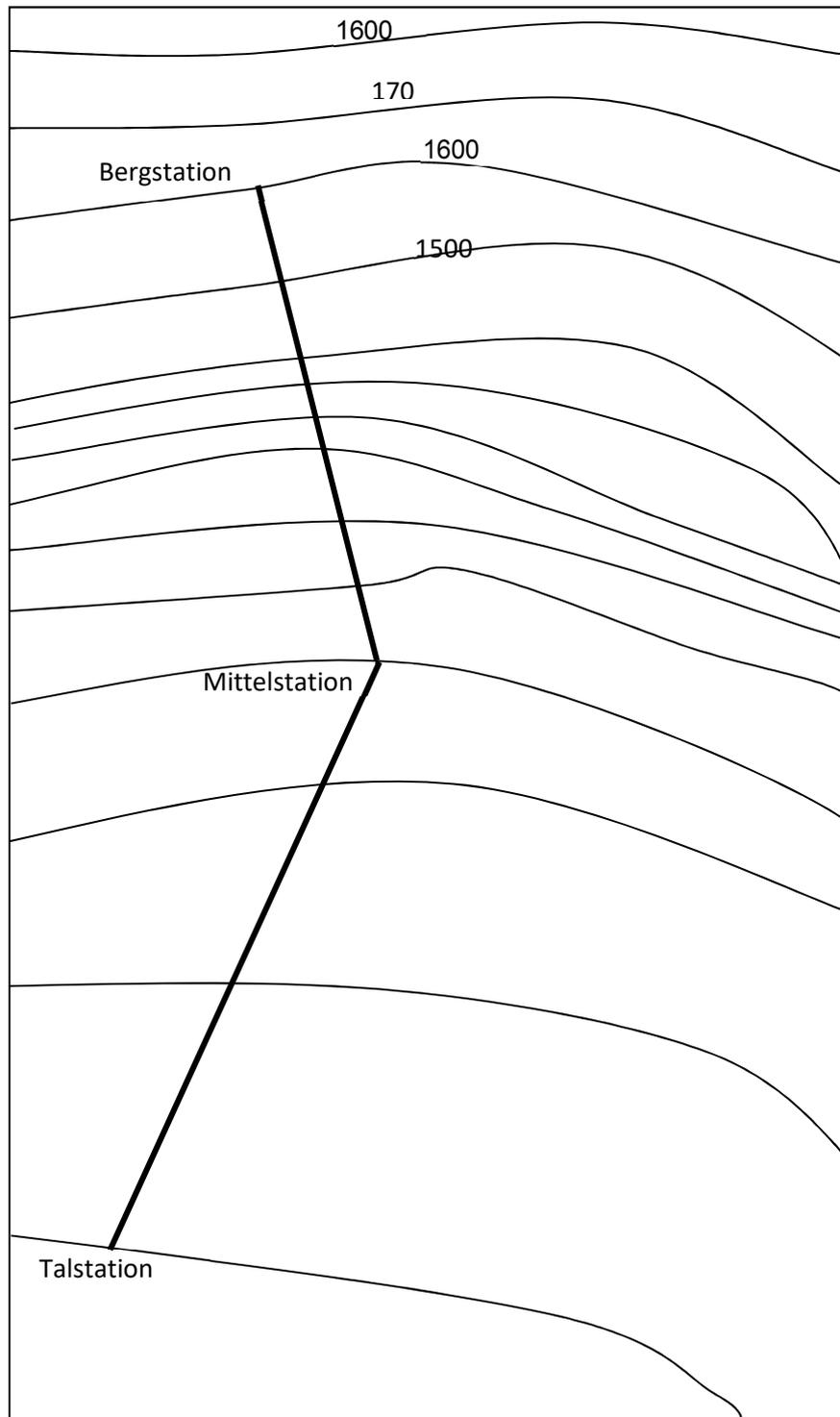
Eine Seilbahn führt von der Talstation über eine Mittelstation zur Bergstation, die in 1600 Meter Seehöhe liegt.
